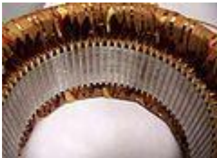
Figure I.3 : Stator d'une machine asynchrone, [6].
